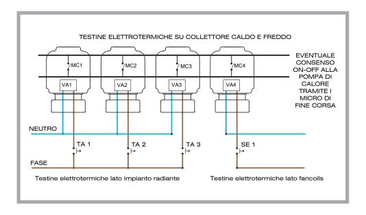
Sopra è riportato lo schema di installazione per l'allacciamento di più comandi dotati di microinterruttore ausiliario (4fili).
